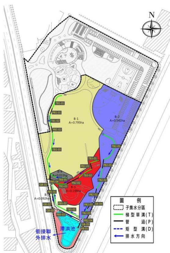
圖 32 開發後集水區排水系統配置圖
