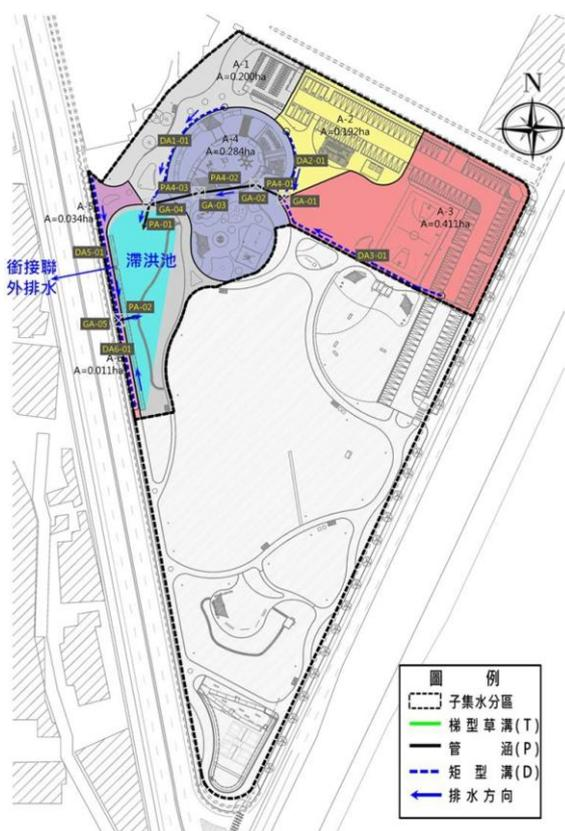
圖 31 開發後北集水區排水系統配置圖
