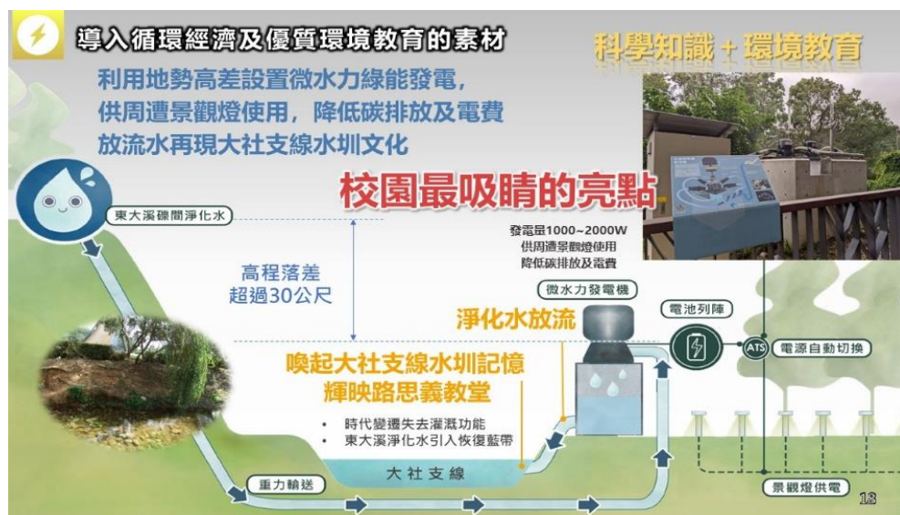
圖 10 全重力式輸水與微水力發電之節能減碳
